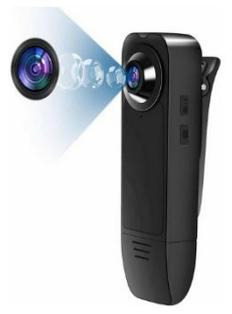
La bodycam che si prevede di fornire ha una risoluzione video 1080p, con rilevamento del movimento, visione notturna con registrazione locale.
